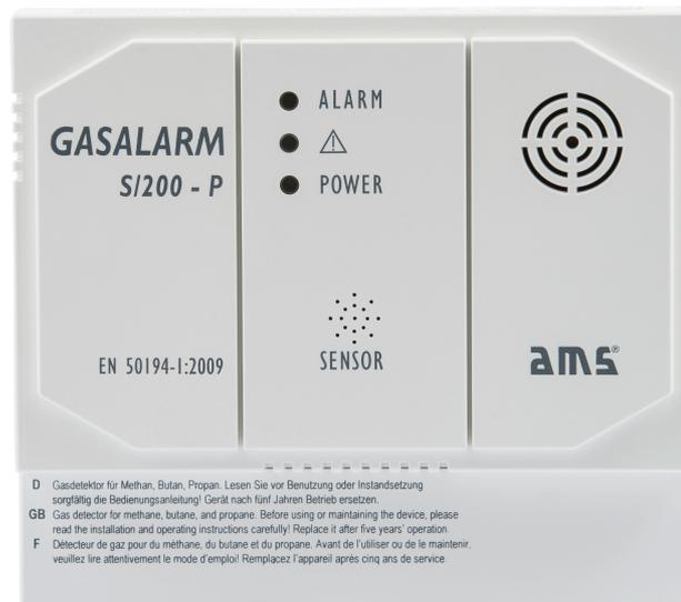
Der Melder S/200-P ist autark einsetzbar und warnt durch eine Sirene. Ein Relaiskontakt ermöglicht z. B. den Anschluss an eine Alarmzentrale, die Steuerung eines Ventils oder einer Belüftungseinrichtung, sowie die Ansteuerung eines Telefonwählgerätes ( I-TEL ). An den zusätzlich vorhandenen 12 V-Alarmausgang kann eine weitere Sirene oder Blitzlampe zur externen Alarmierung angeschlossen werden.
